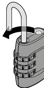
2. Tournez l'étrier à 90° dans le sens inverse des aiguilles d'une montre.
