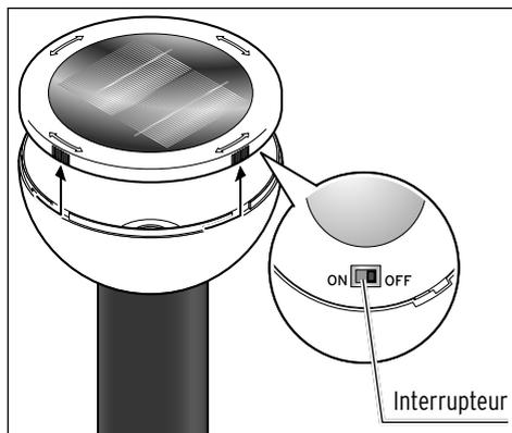
1. Pour chaque luminaire, tournez le cache de la tête de lampe à fond dans le sens inverse des aiguilles d'une montre et retirez-le vers le haut.
