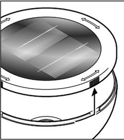
Pour chaque lampe, tournez le cache de la tête de lampe dans le sens inverse des aiguilles d'une montre et retirez-le vers le haut.
