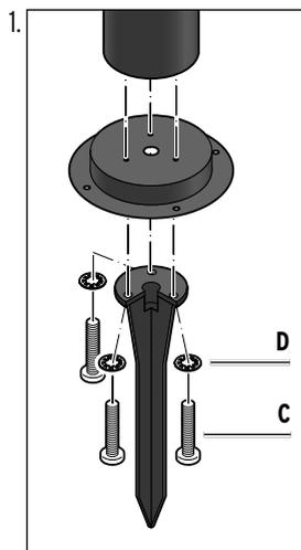
Vissez le piquet et le socle à la colonne de support par en-dessous à l'aide des vis **C** et des rondelles **D**.
