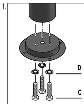
Vissez le socle à la colonne de support par en-dessous à l'aide des vis **C** et des rondelles **D**.
