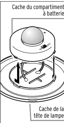
Pour chaque lampe, tournez le cache du compartiment à batterie dans le sens inverse des aiguilles d'une montre et retirez-le vers le haut.
