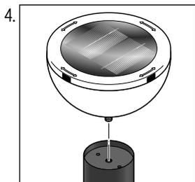
Vissez la tête de lampe dans le filetage en haut de la colonne de support et serrez sans forcer.
