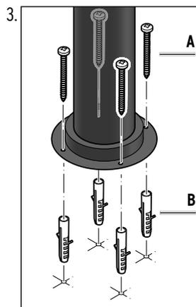
Percez les trous et fixez le socle au sol avec les vis **A** et les chevilles **B**.
