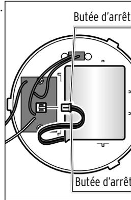
Pressez sur les butées d'arrêt de la fiche de l'ancien pack batterie et retirez la fiche. Utilisez une pince plate si nécessaire.
