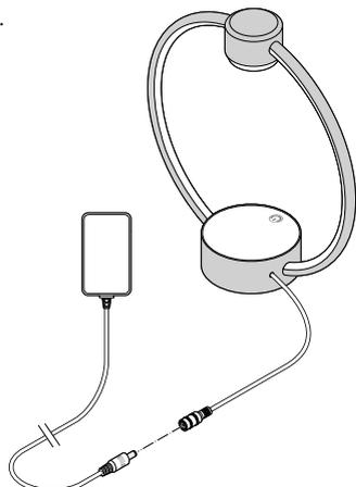
Raccordez l'adaptateur secteur fourni à la prise de raccordement de l'anneau lumineux.
