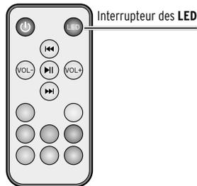
▷ Pour allumer ou éteindre les LED intégrées lorsque la Lune est allumée, appuyez sur l'interrupteur **LED** de la télécommande.
