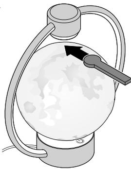
Placez la pièce d'aide au positionnement sur le dessus de la Lune - elle sert à garder la distance entre les deux aimants situés dans la Lune et dans l'anneau lumineux.
