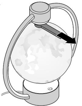
Retirez la pièce d'aide au positionnement avec précaution. Évitez de secouer la Lune lorsqu'elle est en position flottante. Les secousses pourraient faire que la Lune se colle en haut des aimants, ce qui pourrait l'endommager.
