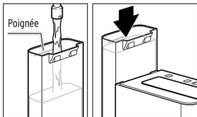
2. Ensuite, remplissez le réservoir d'eau jusqu'à la poignée avec de l'eau fraîche et froide du robinet ou une autre eau potable.
