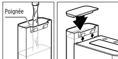
10. Remplissez le réservoir d'eau du robinet froide jusqu'à la poignée et remettez le réservoir dans la machine.
