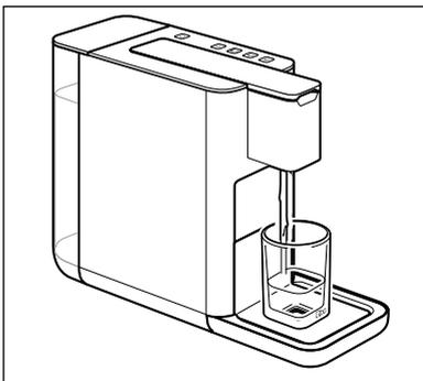
La pompe démarre. Dès que le circuit est rempli, la pompe s'arrête automatiquement. Une petite quantité d'eau coule dans la tasse. La machine émet deux bips sonores.
