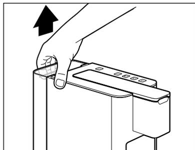
3. Retirez le réservoir d'eau de la machine en le tirant droit vers le haut.
