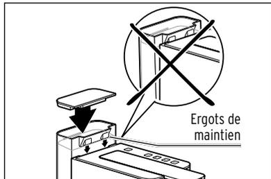
Les deux ergots de maintien du réservoir d'eau doivent s'accrocher à l'arrière du boîtier de la machine. Sinon, il se peut que le réservoir soit penché ou ne soit pas correctement positionné dans la machine.
