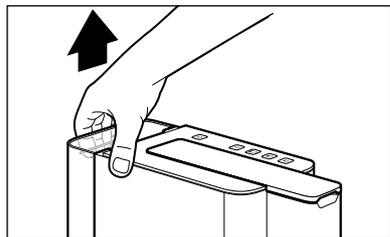
1. Retirez le réservoir d'eau de la machine en le tirant droit vers le haut.
