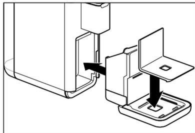
1. Placez le porte-tasse sur le couvercle du bac d'égouttage dans le sens indiqué sur l'illustration.
