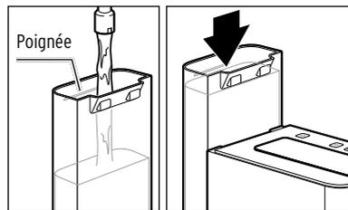
5. Ensuite, remplissez le réservoir d'eau jusqu'à la poignée avec de l'eau fraîche et froide du robinet ou une autre eau potable.
