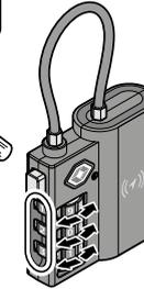
4. Repoussez le bouton de réglage à fond vers la gauche. Vérifiez le fonctionnement: L'étrier doit maintenant pouvoir s'enfoncer dans le cadenas ou se retirer.
