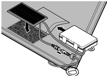
1. Enfichez le connecteur du câble de raccordement dans la prise du module solaire. Serrez l'écrou-raccord à fond pour assurer l'étanchéité de l'assemblage.
