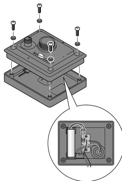
3. Desserrez les vis situées sous le module solaire avec un tournevis cruciforme et retirez le cache. Faites attention à ne pas arracher de câbles!
