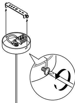
3. Dévissez les deux vis latérales fixant l'étrier de plafond au support du luminaire jusqu'à ce que vous puissiez retirer l'étrier.
