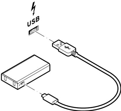
3. Branchez la batterie à un adaptateur secteur avec port USB (non fourni) à l'aide du câble de charge USB fourni.
