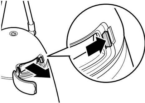
2. Poussez le levier de sécurité sur le côté et retirez la batterie.
