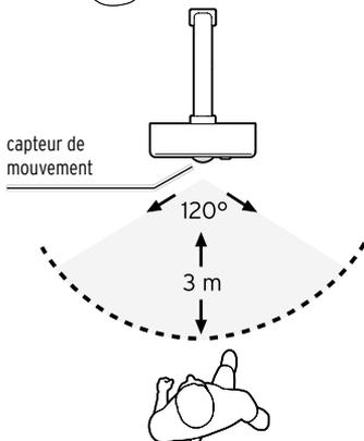
Dans la pénombre ou l'obscurité, quand quelqu'un pénètre dans l'angle de détection de la veilleuse, celle-ci s'allume pendant env. 60 secondes, puis s'éteint automatiquement. La lumière d'orientation côté extérieur est blanc chaud, la LED côté intérieur éclaire en changeant de couleur.
