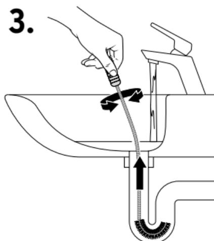
... puis, retirez-la lentement en la faisant également tourner à droite et à gauche.
