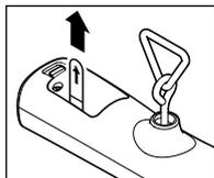
▷ Pour activer la batterie, retirez la bande isolante du compartiment à pile.
