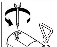
1. ... desserrez le vis sur le couvercle du compartiment à pile à l'aide d'un tourne-vis et ...
