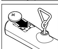
2. Retirez la pile usagée et insérez la nouvelle pile dans le compartiment à pile, pôle positif vers le haut.
