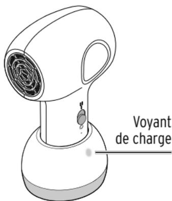
**i** Le témoin de charge s'allume également en vert lorsque la station de charge est connectée mais que le sèche-cheveux n'est pas raccordé à la station de charge.
