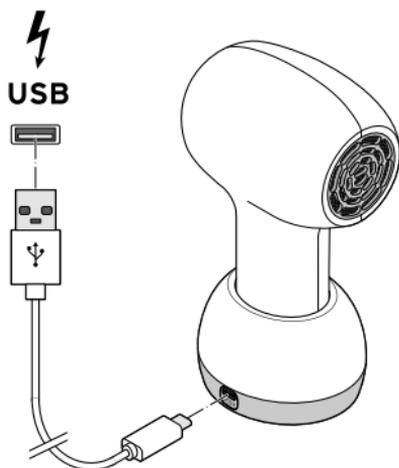
1. Raccordez le câble de charge USB fourni au port USB-C **DC5V** de la station de charge et à un adaptateur secteur USB approprié (voir «Caractéristiques techniques»). Branchez l'adaptateur secteur dans une prise de courant.
