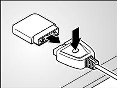
Débranchez la fiche de raccordement de l'unité de commande de la prise de raccordement de la couverture chauffante. Pour ce faire, appuyez sur le bouton situé au-dessus de la fiche de raccordement pour la libérer du verrouillage.
