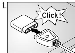
1. Connectez la fiche de raccordement de l'unité de commande dans la prise de raccordement de la couverture chauffante comme sur l'illustration. La fiche de connexion doit s'encliqueter.
