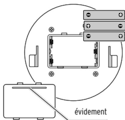
2. Pour enlever le couvercle du compartiment à piles, passez sous l'évidement situé en dessous et soulevez-le.
