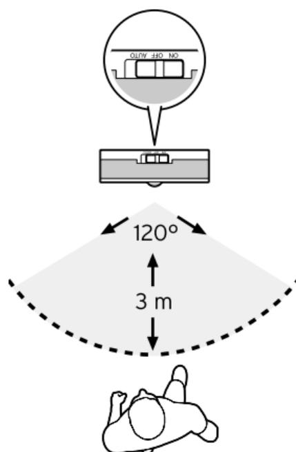
**ON** Pour allumer le luminaire de façon permanente, poussez l'interrupteur sur **ON**.
