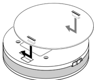
4. Remettez le couvercle du compartiment à piles correctement en place.
