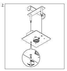
Dévissez les deux vis de fixation situées sur la **face inférieure du support** pour retirer l'étrier de fixation du support.
