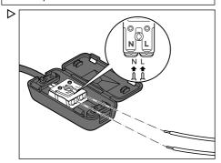
Demandez à un personnel qualifié de brancher les câbles électriques sur le domino dans le boîtier de raccordement.
