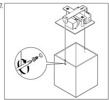
Placez le boîtier de raccordement entre l'étrier de fixation et le support. Fixez ensuite de nouveau l'abat-jour à l'étrier de fixation.
