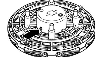
Pour la mise en marche, maintenez l'interrupteur appuyé pendant env. 3 secondes. La LED verte s'allume.
