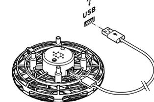
Éteignez l'appareil et raccordez-le à une prise USB adaptée.
