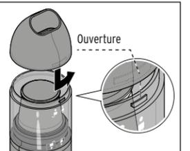
3. Mettez la buse d'aspiration sur le boîtier de manière à ce que l'ouverture sur la face intérieure de la bus d'aspiration soit dirigée vers le symbole du bac à poussière. Tournez ensuite la buse d'aspiration dans le sens inverse des aiguilles d'une montre vers le symbole (voir illustration).
