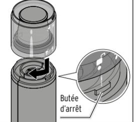
2. Mettez le bac à poussière sur le boîtier de manière à ce que la butée d'arrêt du boîtier soit dirigée vers le symbole du bac à poussière. Tournez ensuite le bac à poussière dans le sens des aiguilles d'une montre vers
