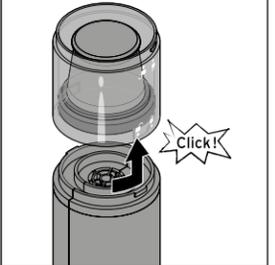
4. Tournez le bac à poussière dans le sens inverse des aiguilles d'une montre jusqu'à la butée, puis retirez le bac à poussière du boîtier.
