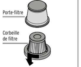
1. Tournez la corbeille de filtre dans le sens des aiguilles d'une montre jusqu'à la butée puis retirez-la du porte-filtre.
