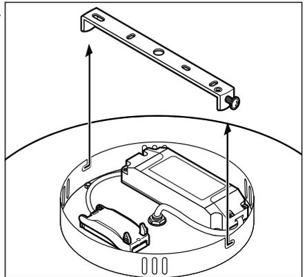
Dévissez les deux vis latérales fixant l'étrier de la suspension au cache-fils jusqu'à ce que vous puissiez retirer l'étrier.
