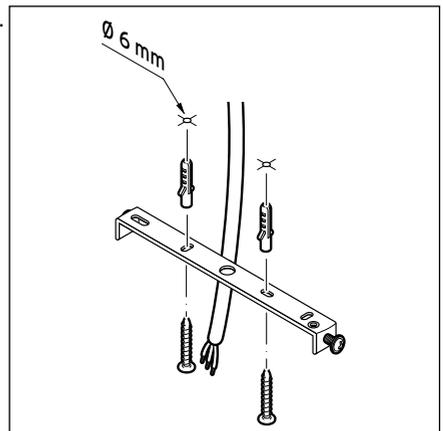
Passez les fils électriques (câble de plafond) dans le passage de câble de l'étrier de fixation. Fixez l'étrier de fixation au plafond en vous servant des chevilles et des vis.
