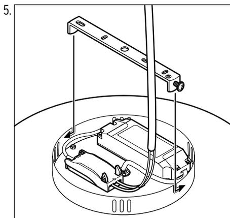
Faites glisser le luminaire sur les vis de fixation légèrement serrées.
