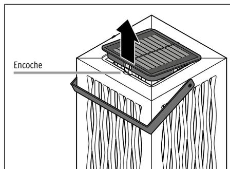
1. Saisissez l'encoche et retirez du support en bambou le module solaire avec la tête du luminaire.
