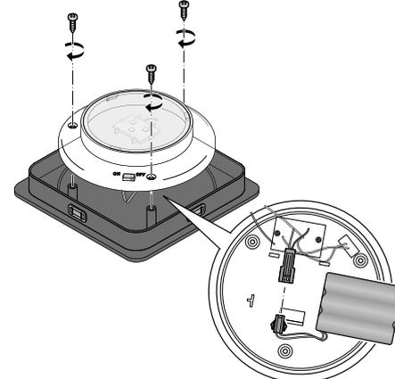
2. Dévissez les trois vis situées sous la tête du luminaire à l'aide d'un tournevis cruciforme.
