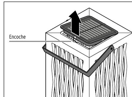
1. Saisissez l'encoche et retirez du support en bambou le module solaire avec la tête du luminaire, puis mettez l'interrupteur situé sous la tête du luminaire en position **OFF** pour désactiver le luminaire.
