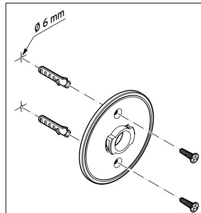
▷ À l'aide des chevilles et des vis, fixez le dispositif de fixation mural à un mur adapté.
