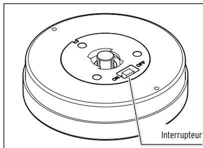
▷ Pour allumer le luminaire, poussez l'interrupteur sur **ON**. Dans cette position, le luminaire fonctionne de manière entièrement automatique:
