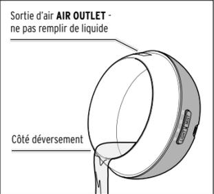
2. Retirez le cache et déversez le reste d'eau dans un tuyau d'évacuation.
