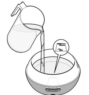
2. Remplissez le réservoir d'eau avec de l'eau tiède (eau potable fraîche ou eau distillée/déminéralisée). Niveau de remplissage minimum env. 250 ml / Niveau de remplissage maximum env. 550 ml.
