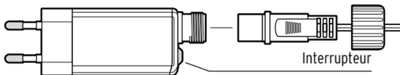
1. Branchez la fiche de raccordement dans la prise du bloc-secteur et serrez bien le capot de protection.
