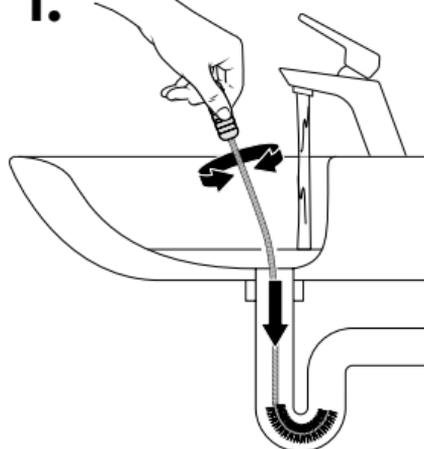
Introduisez la brosse dans le tuyau d'évacuation et faites-la tourner à droite et à gauche, ...
