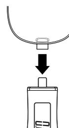
▷ Insérez le cuilleron de pesée jusqu'à la butée dans le logement situé à l'avant du manche. Vous devez l'entendre et le sentir s'enclencher.
