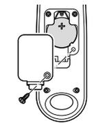
1. ... desserrez la vis du couvercle du compartiment à pile à l'aide d'un tournevis et retirez le couvercle.
